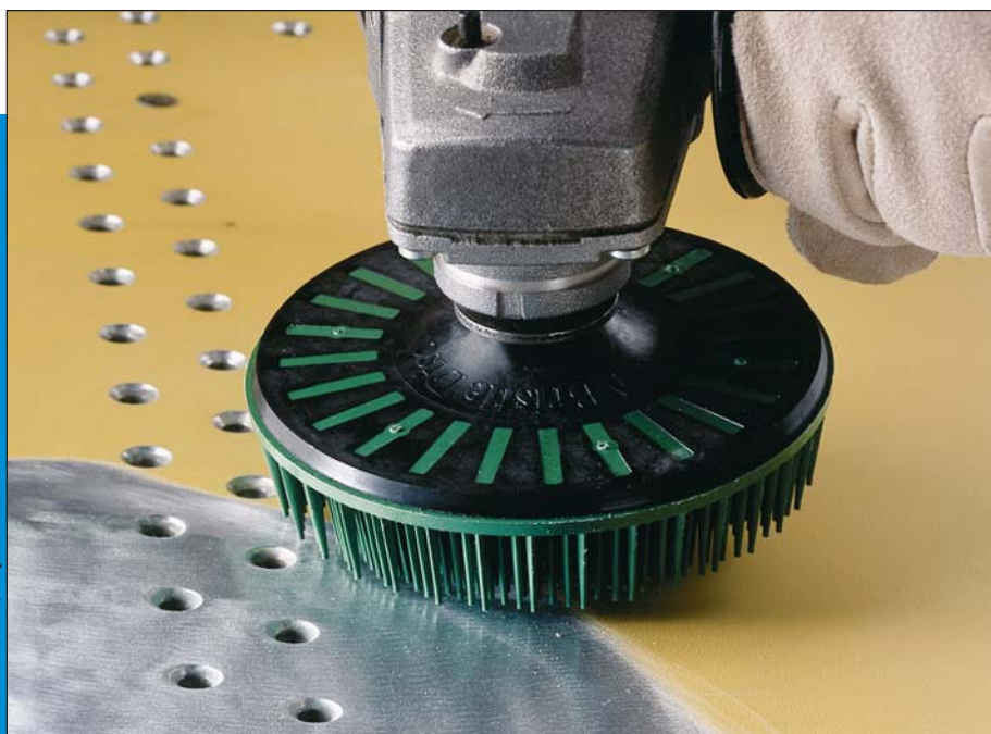
Удаление краски зачистным кругом Scotch-Brite™ Bristle 115 мм, зерно 50
