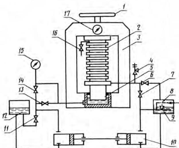
1 - штурвал; 2 - фланцевый коллектор; 3 - рама автоклава; 4 - предохранительный клапан; 5 - гидравлический пресс; 6 - вентиль для слива жидкости коллектора; 7, 13 - обратные клапаны; 8 - запорный клапан холостого хода насоса; 9 - емкость для жидкой среды; 10 - насос; 11 - вентиль холостого хода насоса; 13 - емкость для масла; 14 - вентиль для слива масла; 15 - 17 - манометры; 16 - продувочный вентиль
