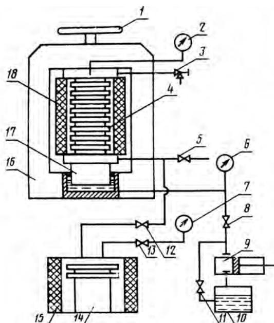
1 - штурвал; 2, 6, 7 - манометр; 3 - вентиль продувочный; 4 - фланцевый коллектор; 5 - вентиль для спуска пара из коллектора; 8 - вентиль для спуска масла; 9 - насос ручной; 10 - емкость для масла; 11 - вентиль холостого хода насосов; 12, 13 - запорные вентили; 14 - котел; 15 - электрообогрев; 16 - рама автоклава; 17 - гидравлический пресс; 18 - электрообогрев фланцевого коллектора
