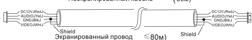
2.3 В обычных неэкранированных кабелях + видео 75-3 способ подключения
