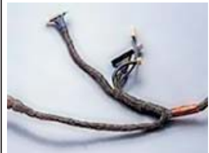
Рисунок 13 Экранирование (а) и гнутирование (б) проводов при помощи оплеток
