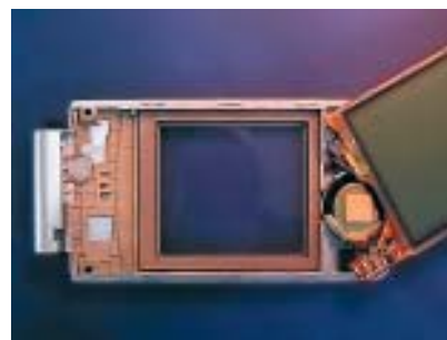
Рисунок 18 Экранирование и уплотнение ЖКИ индикатора
