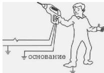
При нормальной работе прибора ток проходит по проводам внутри прибора. По проводу заземления ток практически не проходит.
