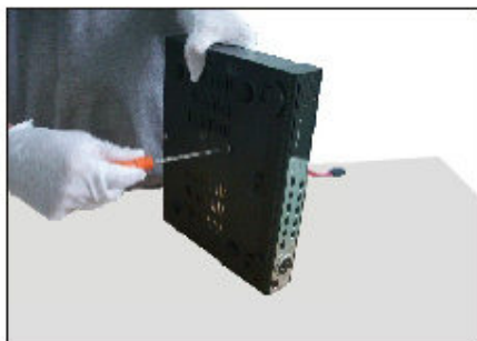
5. Зафиксируйте жесткий диск винтами
