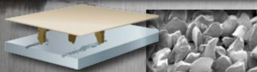
Обычное керамическое абразивное зерно имеет неправильную форму. Такое зерно «вспыхивает» обрабатываемый металл, перегревая его, что снижает скорость обработки и сокращает срок службы абразивного круга.
