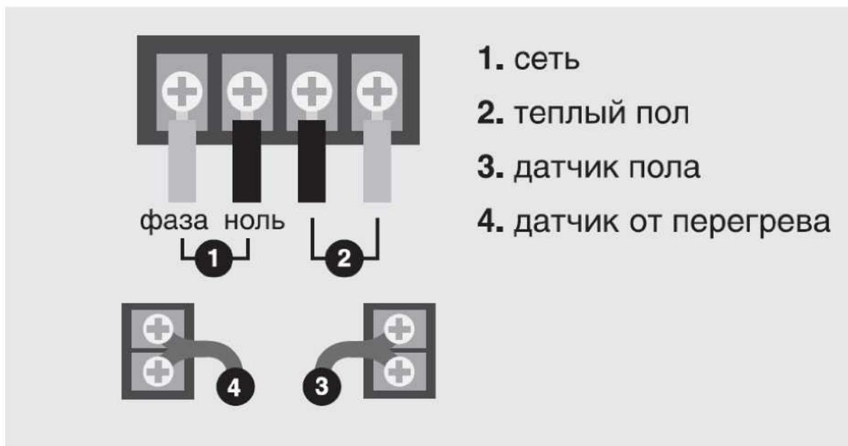
5. Подсоедините провода датчика пола, прикрепив их винтами, установленные на колодке: «SENSOR» — место подсоединения датчика пола, «ОНТ» — место подсоединения дополнительного датчика от перегрева.
