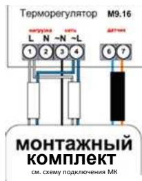
Рисунок 7. Схема подключения терморегулятора М9.16 к системе обогрева с использованием МК
