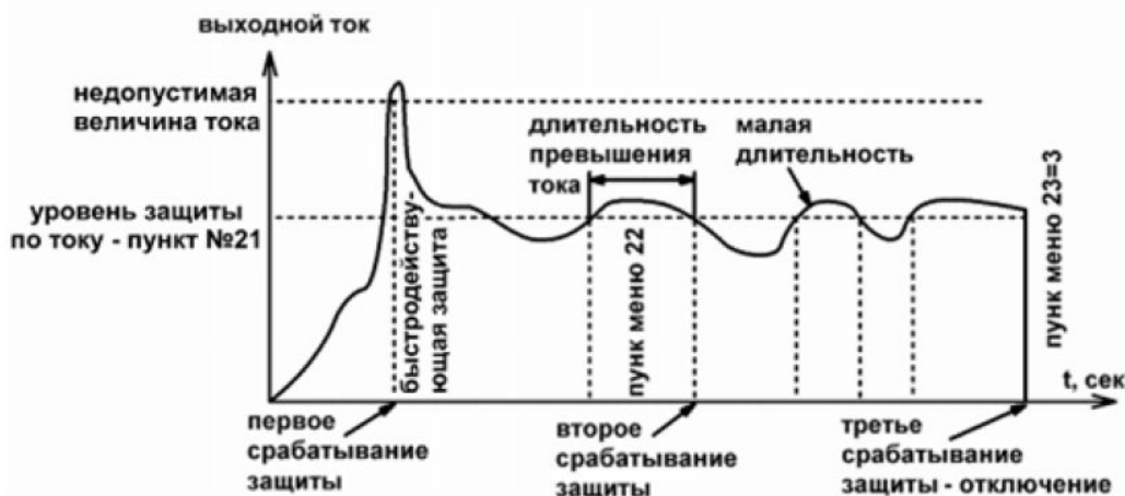
Рисунок 4 – Срабатывание защиты при токовых перегрузках.
