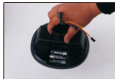
2. Вставте три батареї в батарейний відсік, на задній частині керма відповідно до їх позитивного та негативного полюсів.
