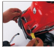
6. Відкрутіть гвинти на кузові.
