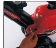
8. Вставте гвинт в отвір для гвинта копального важеля.
