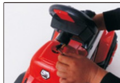
4. Під'єднайте кабель керма до кабелю кузова.
