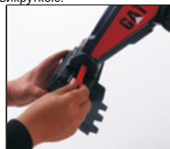
10. Встановіть копальню головку, вирівняйте її з отвором та вставте з'єднувальний вал.
