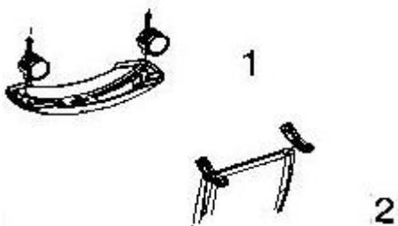
1. Прикрутите колёса спецвинтами к опорной стойке (Винты поставляются в комплекте).
