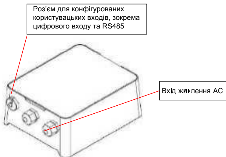
Малюнок 5 - Розташування роз'ємів
