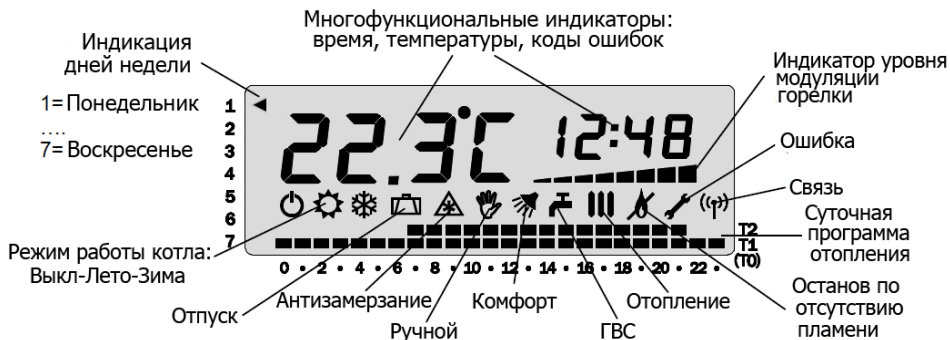
Рисунок 42. Описание ЖКИ-индикатора и отображаемых символов и пиктограмм
