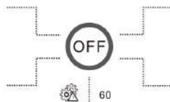
Напруга від PV панелей перевищує допустиму межу
