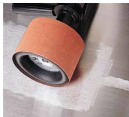
Шлифовка и восстановление заводской риски
