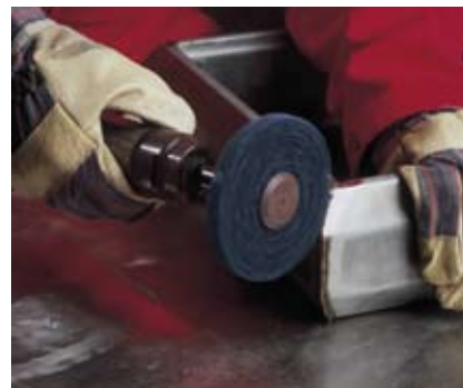
Зачистка стыкового сварного шва
