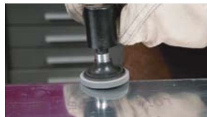
Удаление стыкового шва
