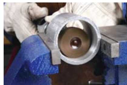
Шлифовка внутренней поверхности цилиндра
