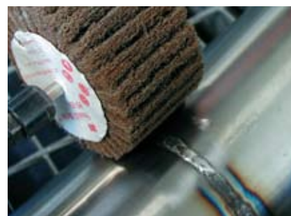
Осветление сварного шва
