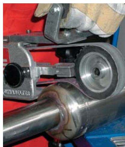
Шлифовка нержавеющей стали
