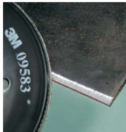
Подготовка кромки листа к сварке
