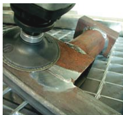
Удаление сварного шва и ржавчины
