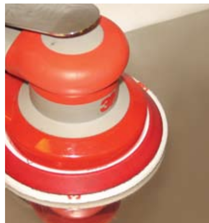
Полировка нержавеющей стали
