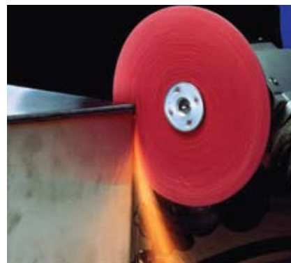
Зачистка сварного шва
