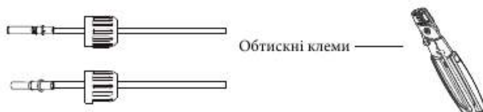
Рис. 5.4 Обтисніть контактний штифт до дроту
