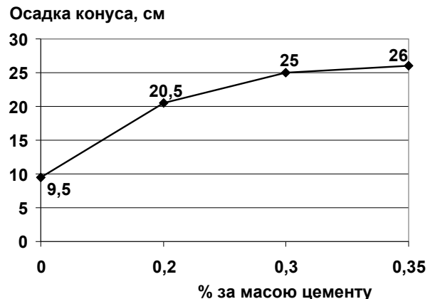
Таблиця 2. Осадка конуса еталонного бетону C20/25, CEM II/B 32,5 (320 кг/м³), водоцементне співвідношення = 0,59.
