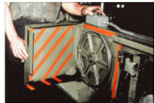
Обозначение потенциально опасных мест: высоковольтного оборудования, опасных сред, опасных мест в машинных отделениях для снижения травматизма
