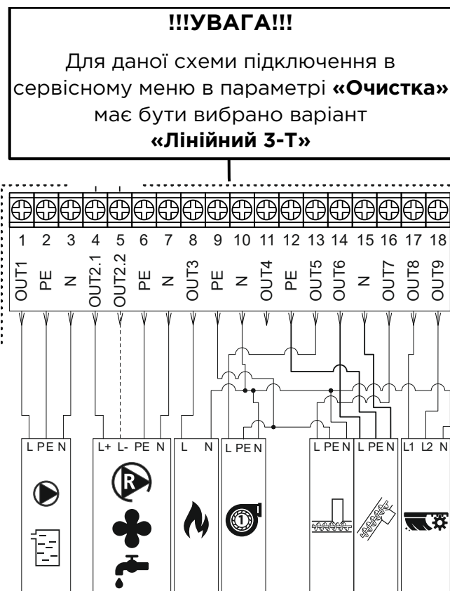
Мал. 15 Схема підключення контролера з 3-х точковим лінійним приводом.
