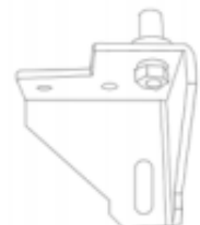
7. Підніміть дверцята на верхній петлі. 8. Затягніть верхній штифт петлі. 9. Зніміть штифт нижньої петлі та поверніть нижню петлю на 90 градусів.
