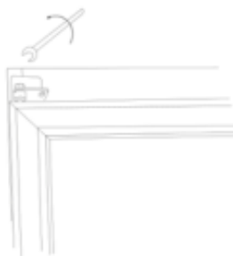
7. Підніміть дверцята на верхній петлі. 8. Затягніть верхній штифт петлі. 9. Зніміть штифт нижньої петлі та поверніть нижню петлю на 90 градусів.
