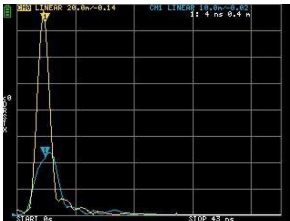
Рис. 8. Приклад імпульсної реакції смужкового фільтра
