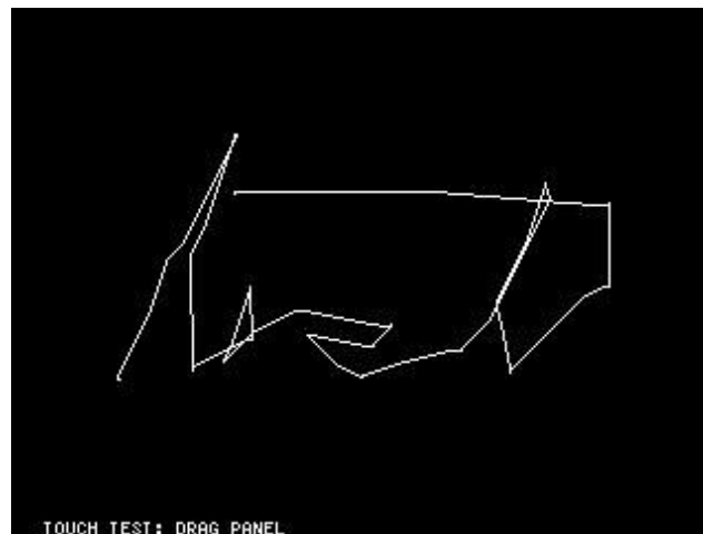
Рис. 5. Тест точності сенсорного екрана
