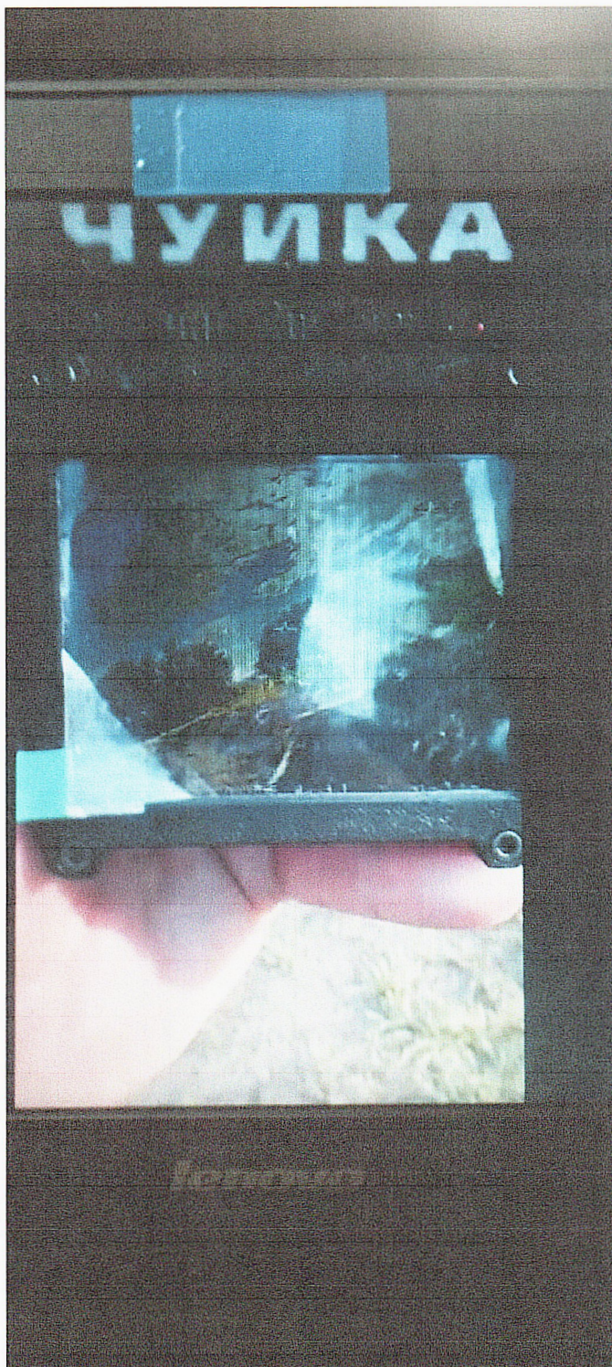
Зображення № 7— відеосигнал на детекторі дронів Чуйука при перехопленні відеосигналу оператора FPV TX/RX (915 МГц), Video (5.8 GhZ на відстані 100 метрів від місця розташування засобу РЕБ «АБВЕР MAXIMUS» під впливом якого було зірвано польотне завдання FPV-дрону.
