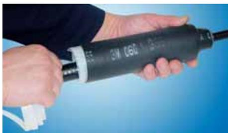
Трубка холодной усадки располагается над коаксиальным соединителем таким образом, чтобы ее конец, противоположный стороне, с которой будет удаляться спиралевидный корд, полностью закрыл намотанный на кабель вспененный материал.
