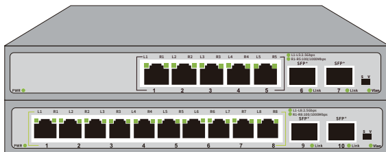
Схема передньої панелі комутаторів серії 2.5G
