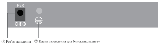
Схема задньої панелі комутаторів серії 2.5G
