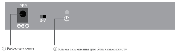
Схема задньої панелі комутаторів серії Full Gigabit (із зовнішнім блоком живлення)
