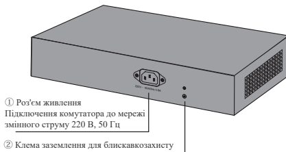
Схема задньої панелі комутаторів серії Full Gigabit (із вбудованим блоком живлення).
