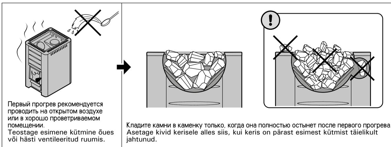
**Рисунок 2. Подготовка каменки и укладка камней**
