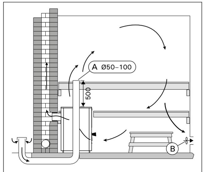
Рисунок 4. Механическая вытяжная вентиляция
