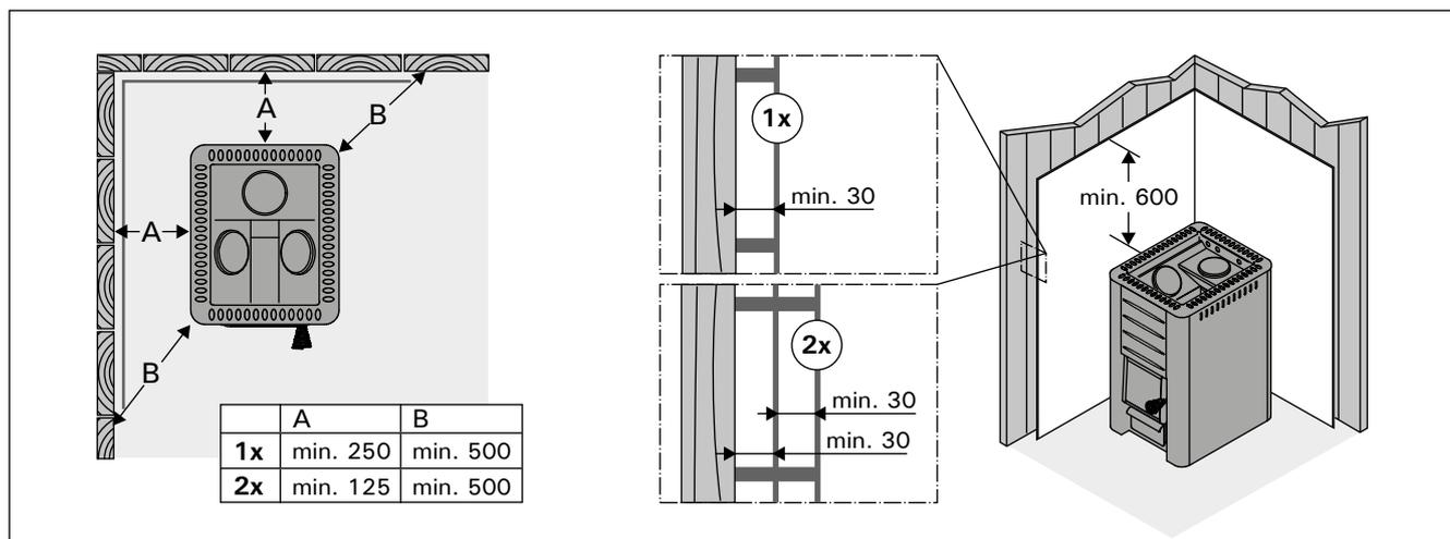
Рисунок 7. Защитные покрытия (все размеры приведены в миллиметрах)
