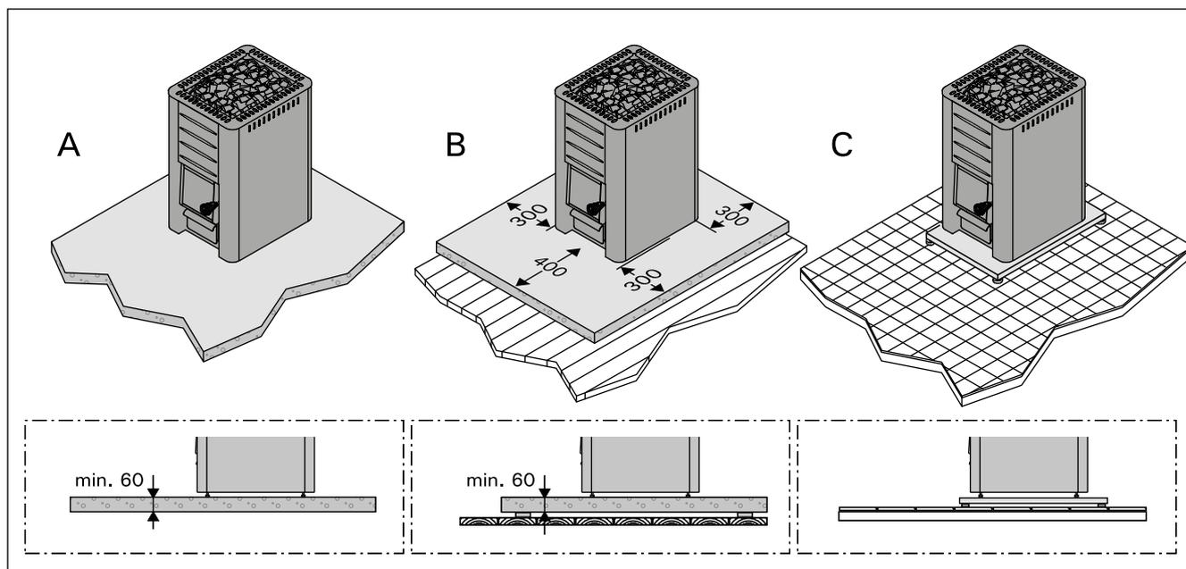
**Рисунок 5. Защита пола (все размеры приведены в миллиметрах)**
