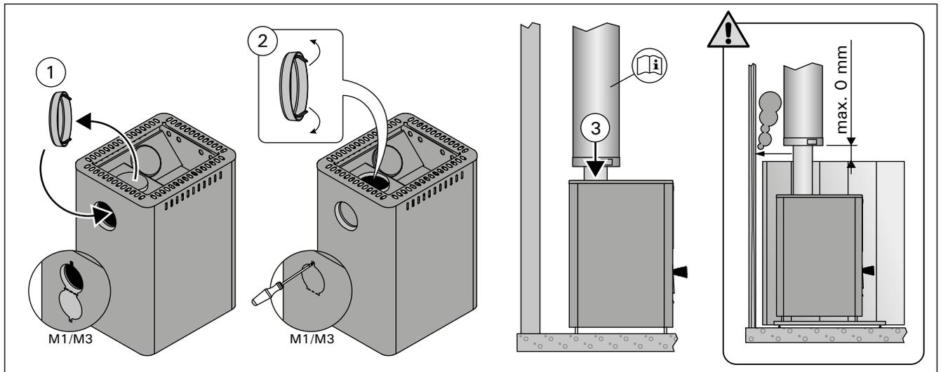
Рисунок 11. Присоединение печи к стальному дымоходу Harvia (все размеры приведены в миллиметрах)
