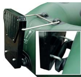
Пластиковый навесной транец для надувной лодки
