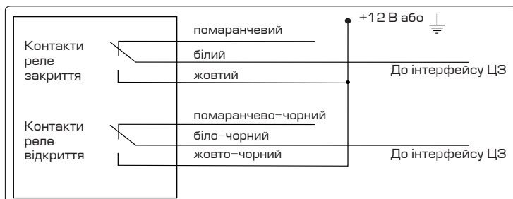
Схема підключення до двопроводних приводів ЦЗ
