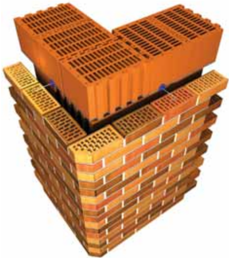
Кут будинку 90° на прикладі фасонної цегли Ф2
