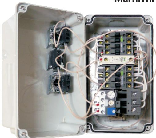
Магнітні пускачі ПММ в оболонці з термостійкого пластику зі ступенем захисту IP-67 призначені для дистанційного пуску і зупинки трифазних асинхронних двигунів з короткозамкненим ротором на напругу змінного струму до 400В, а також для захисту електродвигунів від перевантажень надмірної тривалості і надструмів, що виникають при обриві однієї з фаз.
