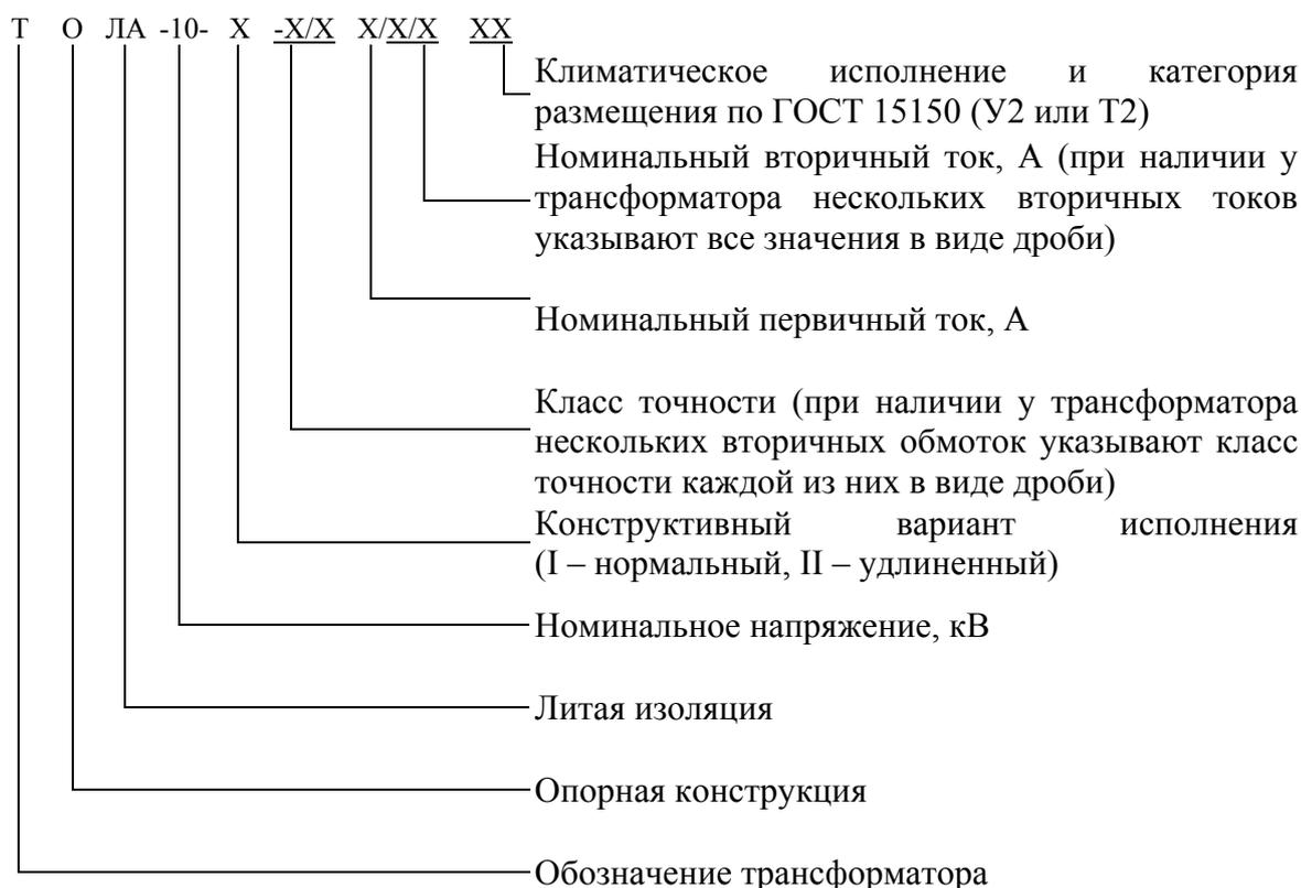
Пример условного обозначения трансформатора при заказе:
