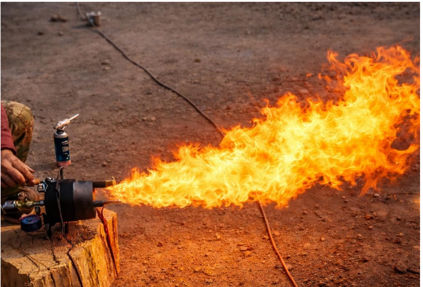
Мал. 3: Зразок факелу при нормальній роботі пальника
