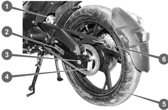
Рис. 6.7. Ланцюгова передача і маятникова підвіска
