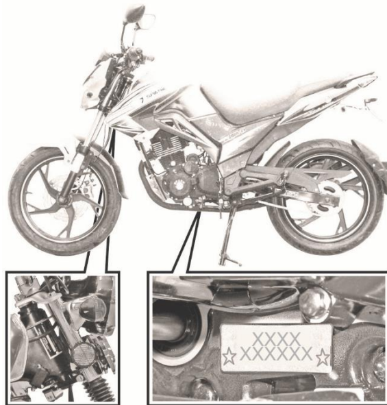
Рисунок 3.7. Розташування номера двигуна мотоцикла
