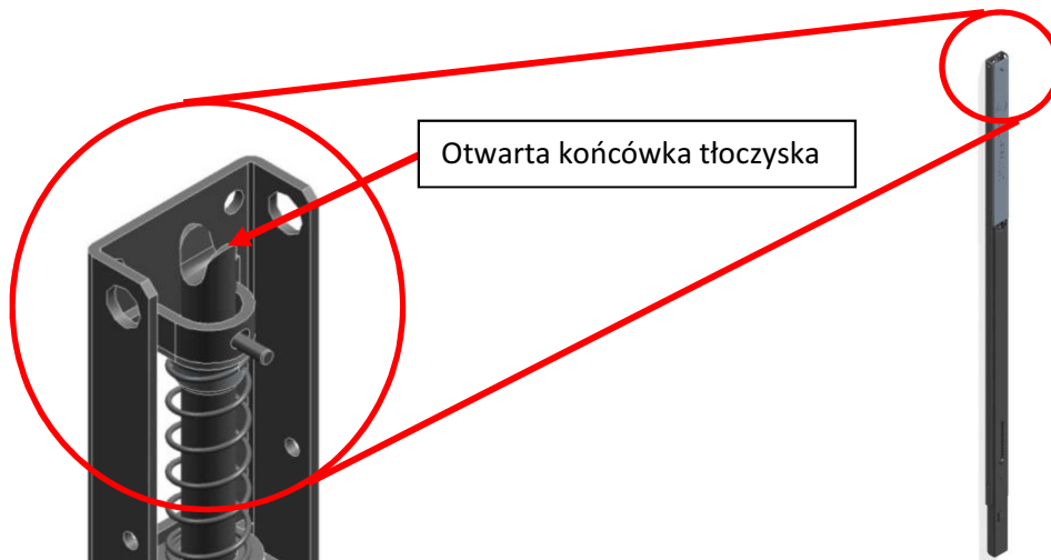
Rysunek 7: Górna część mechanizmu podnoszenia z nową końcówką tłoczyska (widok bez osłony blaszanej)
