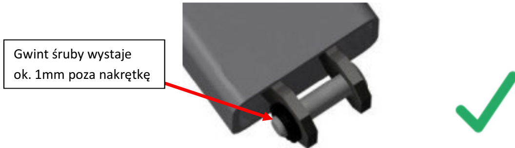
Rysunek 5: Prawidłowo dokręcona nakrętka
