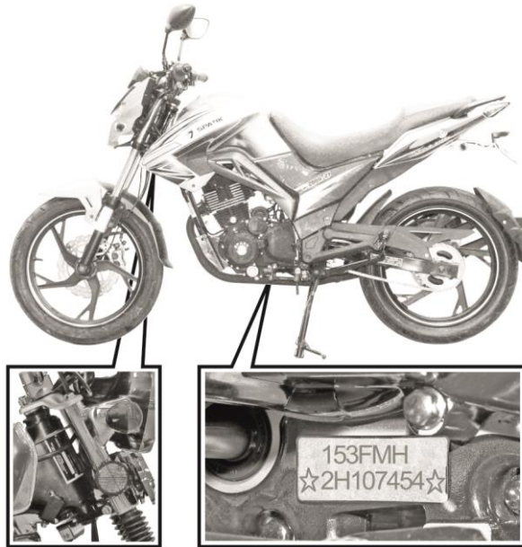
Рисунок 3.7. Розташування номера двигуна мотоцикла
