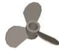
Морський гвинт із 3 лопатями, кут 35°
