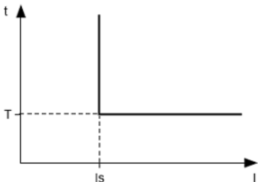
Рисунок 1.4. Принцип защиты с независимой выдержкой времени
