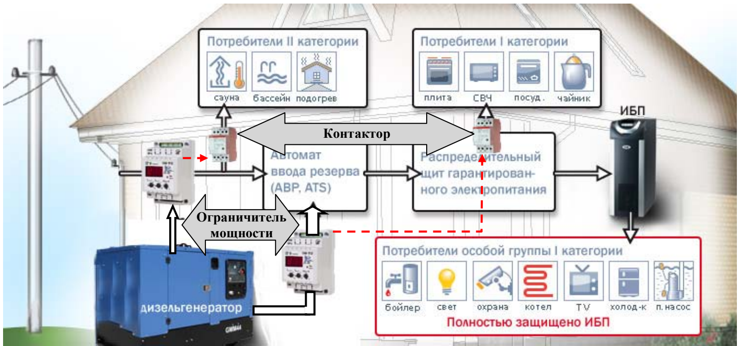
Рис. 3. Пример схемы управления нагрузкой в условиях ограниченной мощности с разбиением потребителей на категории.
