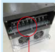
Ступінь захисту для обведена область – IP00; інші області мають IP20
