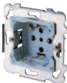
Новый тип механизмов розеток со степенью защиты IP20 со снятым обрамлением. Новые контакты Stai с двойным изгибом (принцип английской булавки) обеспечивают надежную работу на протяжении всего периода эксплуатации, независимо от количества включений. Двойные туннельные клеммы позволяют соединять розетки между собой. Клеммы оснащены винтами для быстрой фиксации и специально спроектированными пластинами, обеспечивающими максимальную площадь контакта.
