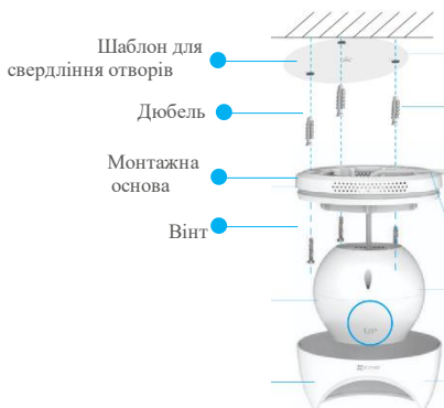
Малюнок 1. монтаж на стелю
