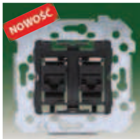
Gniazdo komputerowe podwójne RJ45 kat6 18586-2 2 niezależne złącza 8-pinowe Zaciski nacinające izolację i samozaciskające się na przewodzie
