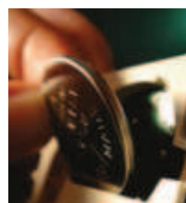
Wbudowany akumulator litowy o napięciu 3 V i trwałości 10 lat. Metalowy pasek sprężynujący blokuje przestrzeń, w której znajduje się akumulator i pozwala na jego łatwą oraz szybką wymianę bez obawy o zagubienie.
