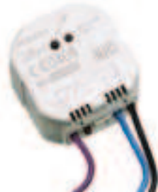
RF265625 Ściemniacz 250 W jarzeniowe i dwubarwne z transformatorem elektronicznym. Nie używać z transformatorami ferromagnetycznymi.
