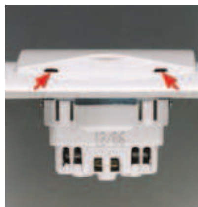
Dwa otwory umieszczone w dolnej części gniazda elektrycznego zapewniają wydostawanie się wody na zewnątrz.
