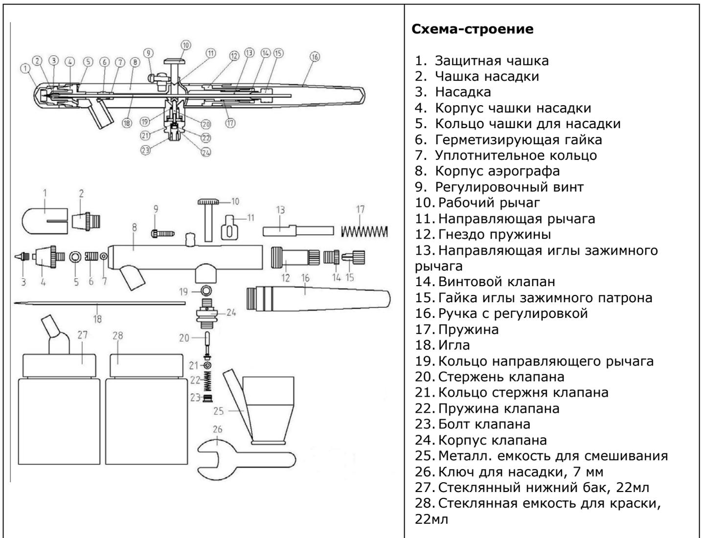
Комплектация: аэрограф, нижний бак (22мл), емкость для краски (22мл), металл. емкость для смешивания красок (5мл), ключ для сопла, штуцер для шланга, инструкция.
