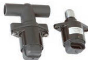
35PM42Z 57мм 0.0417мм/шаг 20Н; 12V; 0,23А; 12мм Для регулирования холостого хода автомобилей
