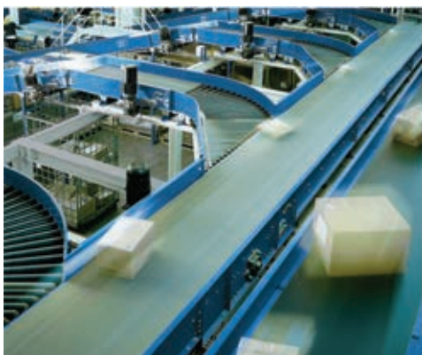
Транспортная система с Drive PLC и 8200Motec
