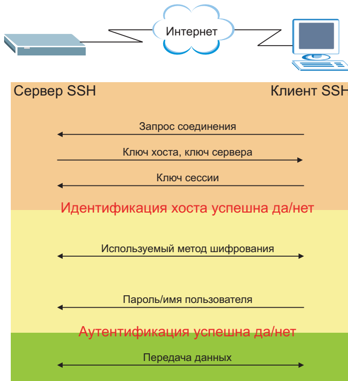
Рисунок 228 Как работает протокол SSH
