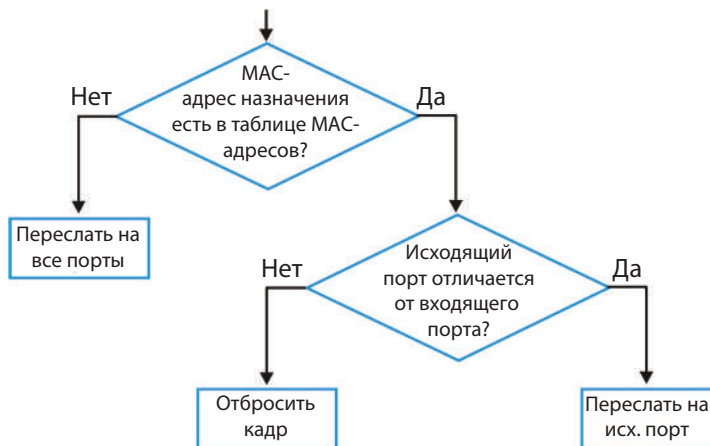
Рисунок 245 Схема работы таблицы MAC-адресов
