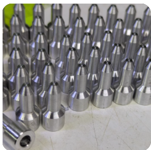
Втулки токарні на ЧПК за кресленням
