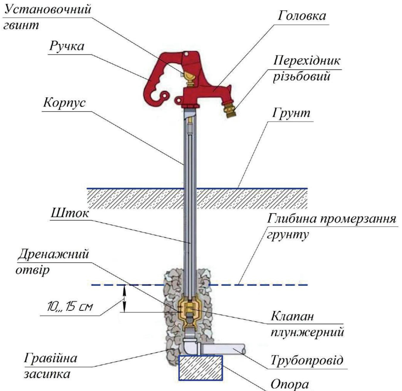
Рис. 1 Загальний вигляд колонки-гідранту
