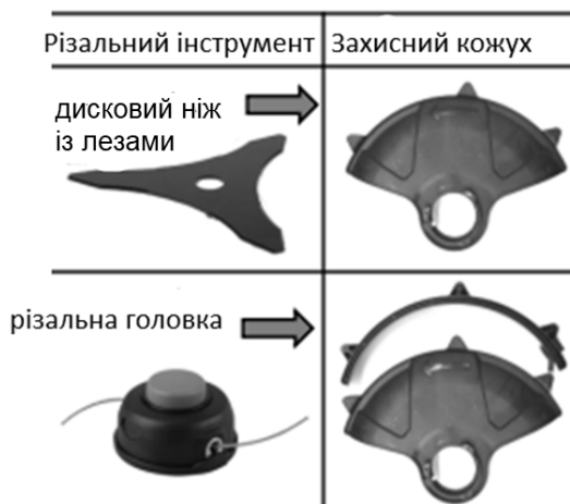
Рисунок 4. Комбінації використання різального інструменту із захисним кожухом.
